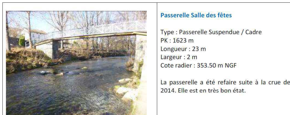
FIGURE 26 : FICHE DESCRIPTIF DE LA PASSERELLE (SOURCE : ANTEA, 2017)
